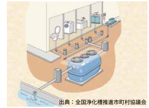
家庭用の浄化槽 (地下にうめてあります)
